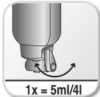
Actionner le levier et doser en fonction de l'application et du degré de salissure.
